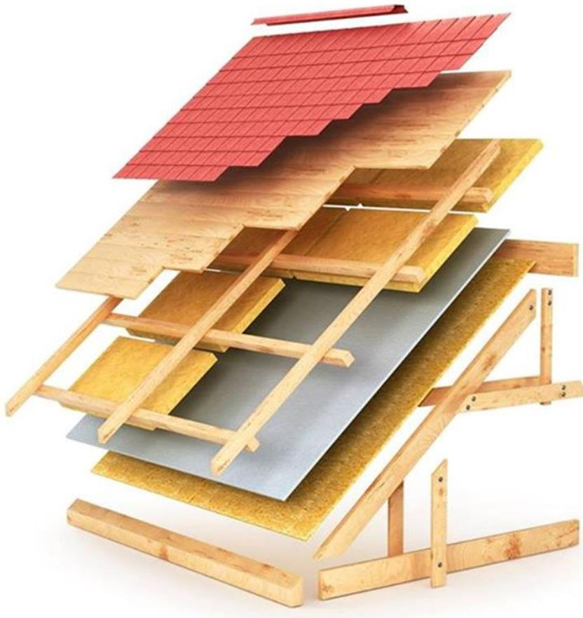
Abbildung 4-1: Querschnitt einer Zwischensparrendämmung (Ratgeber Dämmen, 2019)
